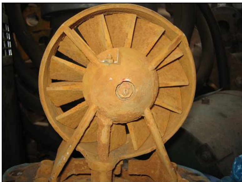
شکل ۲-۱: فرسایش ساختار یک کنتور و افزایش احتمال ایجاد خطا در اندازه‌گیری [۲]
